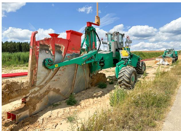
Abbildung 5: Der Kabelpflug mitsamt Schwert wird von einer Winde über den Baugrund gezogen.
